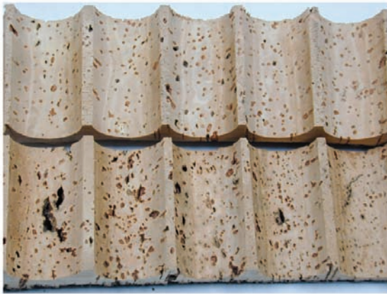
Variation de la porosité dans une planche de liège après ponçage de bouchons
